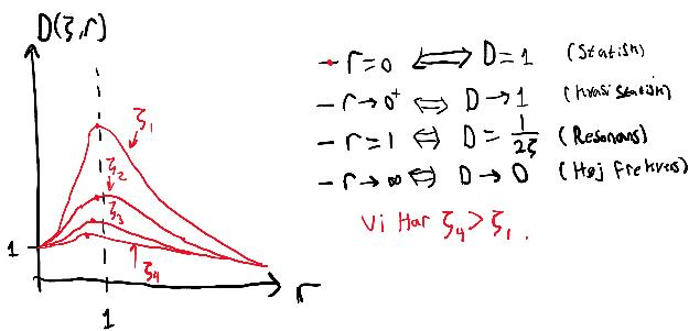
Jo mindre dæmpningsforholdet  $\zeta$  er, jo højere er forstærkningsfaktoren. Det vil altså sige, at den dynamiske flytning er højere i forhold til den statiske flytning, når vi har lav dæmpning.
